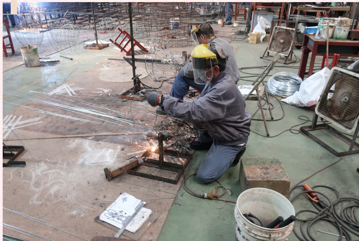
花燈骨架焊接
